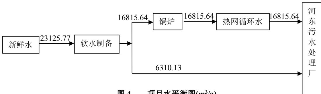
**图 4 项目水平衡图(m<sup>3</sup>/a)**
