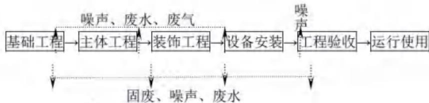
图 4 施工期污染工艺及产污环节图
