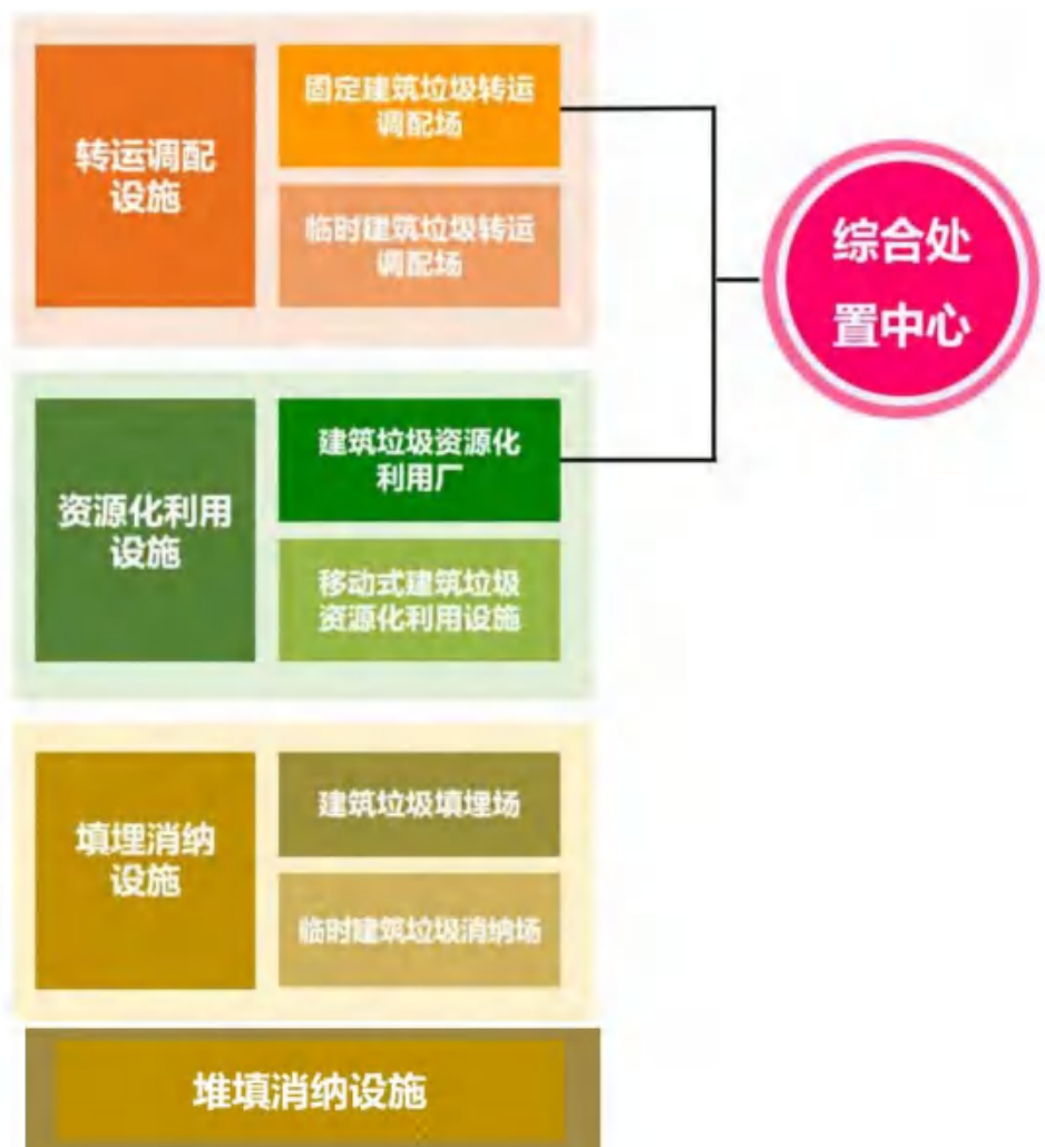
图 8-2 建筑垃圾处理设施系统组织结构图
